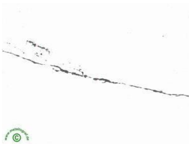
ترک های روی سطح ماده و آخال های غیرفلزی (سرباره ها) بعنوان عامل ایجاد ترک های داخلی ، بزرگنمایی ۶۰۵X و
