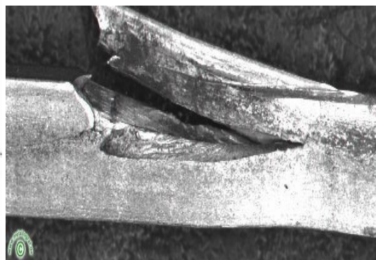
ترک های روی سطح ماده و آخال های غیرفلزی (سرباره ها) بعنوان عامل ایجاد ترک های داخلی ، بزرگنمایی ۶۰۵X و
